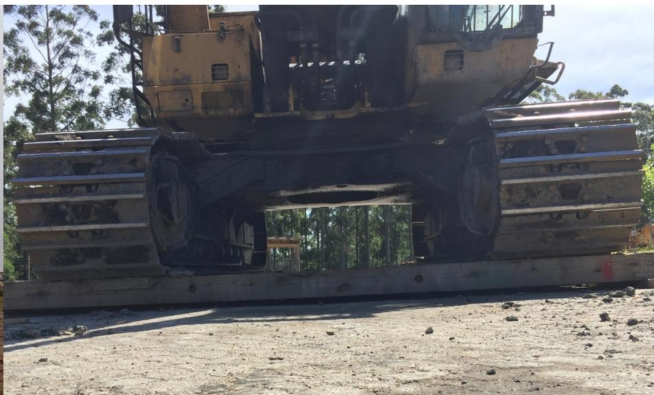
Teste de flexão de *mats* padrão B 5.5 m x 192 mm x 1.15 m.
